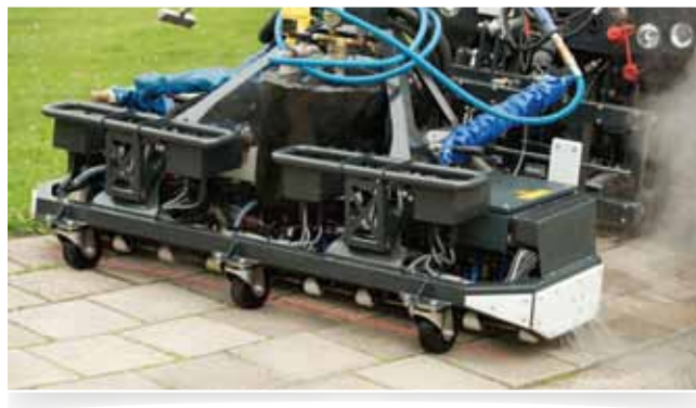
Élimination ciblée des mauvaises herbes grâce à la présence de capteurs
